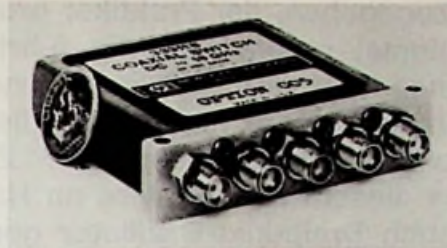
Bild 5: Praktische Ausführung des Koaxialumschalters (Hewlett Packard-Presebild)
